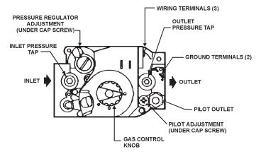
HONEYWELL GAS VALVE FOR I.I.D. SYSTEM (TOP VIEW)
